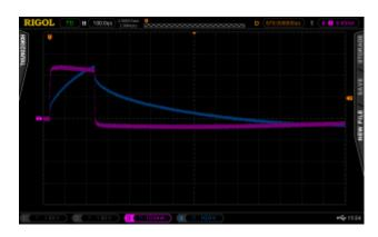
Der Widerstand wurde aus der Steigung der geneigten IV-Segmente in der XY-Zeitachse und die Kapazität mit I\*t/V aus der YT-Zeitachse bestimmt. Die resultierende Schaltung würde mich einem Elektrolytkondensator nachgebildet und die IV, IT+VT Diagramme verglichen. Das Modell hat einen guten Ansatz für ein erstes Verhalten ergeben.
